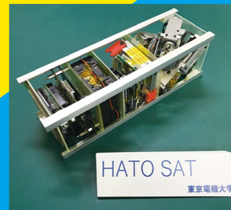
開発中の小型人工衛星(10cm×10cm×30cm)
