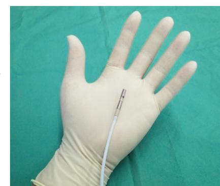
カテーテル式血液ポンプ(直径4mm)の試作機
