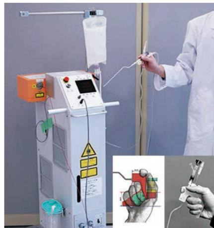
微量の水を高速で撃ち出し腫瘍や組織を破碎する
