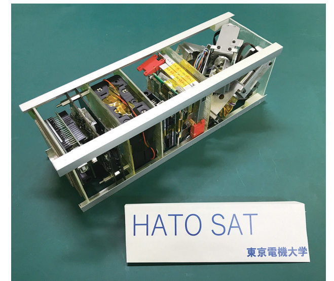
開発中の小型人工衛星 (10cm×10cm×30cm)
